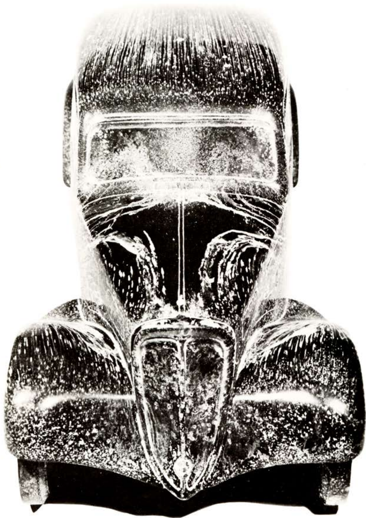
Étude d'aérodynamique sur la Traction avant : le parcours des filets d'air était matérialisé par projection de lait de chaux.
