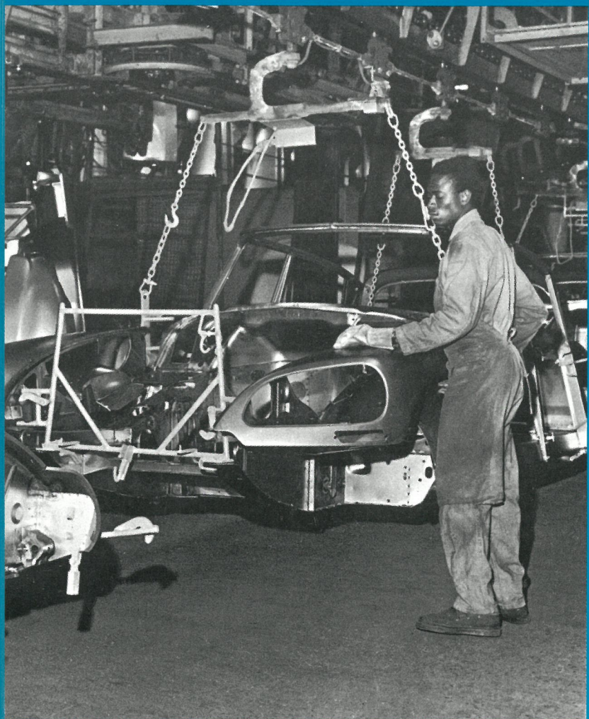
4. Accrochage des éléments de la robe, sur la caisse : la carrosserie est prête pour les opérations de peinture.
