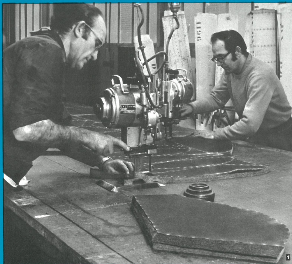
1. La découpe d'un « matelas » : ici vingt-cinq épaisseurs de targa destiné aux garnitures. Le tracé des pièces apparaît en blanc. (Talc passé à travers les perforations des patrons de découpe.)
